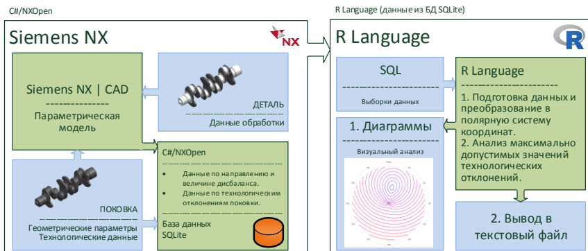
Рисунок 2 – Общая схема взаимодействия компонентов программы технологического обеспечения балансировки деталей с необрабатываемыми поверхностями.
