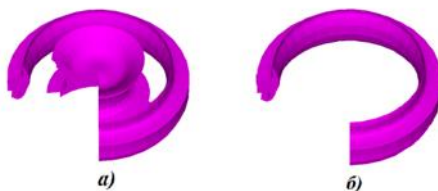
Рисунок 3 - Пробитие стальной преграды кольцевым кумулятивным пестом:
