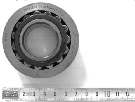
Рисунок 2 – Второй роликоподшипник вала ТНВД без видимых повреждений
