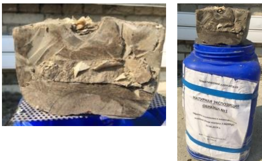
Рисунок 3 - Вид материала после натурной экспозиции
