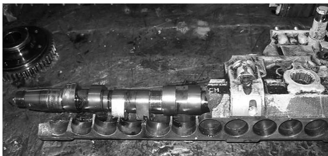
Рисунок 1 – Разрушение корпуса топливного насоса высокого давления
