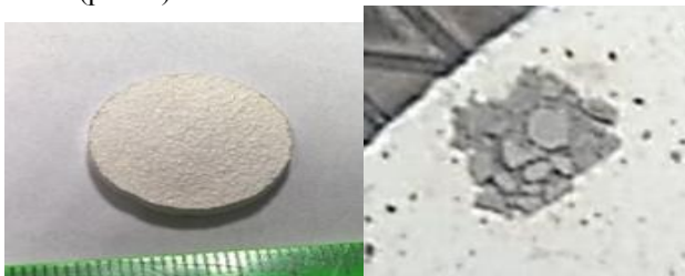
Рис. 3. Фотографии образцов после отжига при 1000 Co на воздухе: образец полученный из чистого нанопорошка YSZ(слева), рассыпавшийся образец из нанопорошка YSZ с 10%масс.MoSi 2 (справа)
