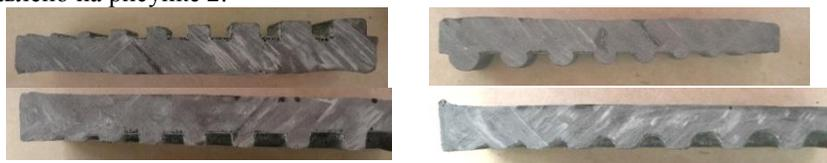
Рисунок 2. Разрез образцов для определения воспроизводимости рельефа.
