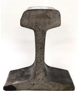
Рисунок 1 – Усталостный излом рельса
