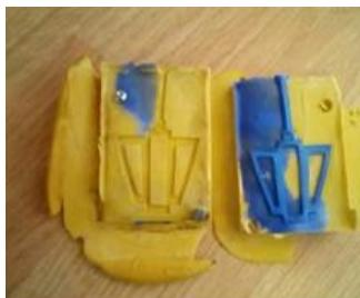
Рис.5. Изготовление восковок.
