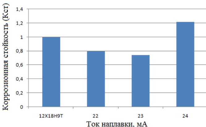
Рисунок 2– Распределение значений относительной коррозионной стойкости образцов
