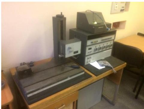
Рисунок 2-Профилограф-профилометр 252
