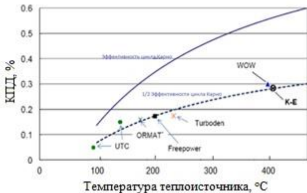
Рисунок 2 – Зависимость КПД паросилового цикла на низкокипящих рабочих телах от температуры
