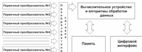
Рисунок 1 - Обобщенная структурная схема интеллектуального датчика.
