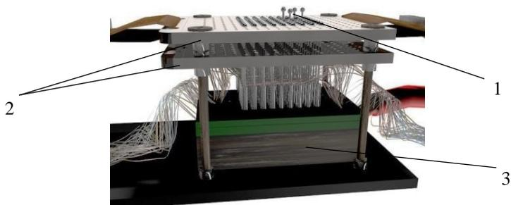
Рисунок 1 — Многоэлектродный зонд для исследования электрических параметров кожного покрова
