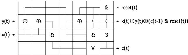
Рис. 1. Пример последовательной клеточной схемы потокового сумматора со сбросом
