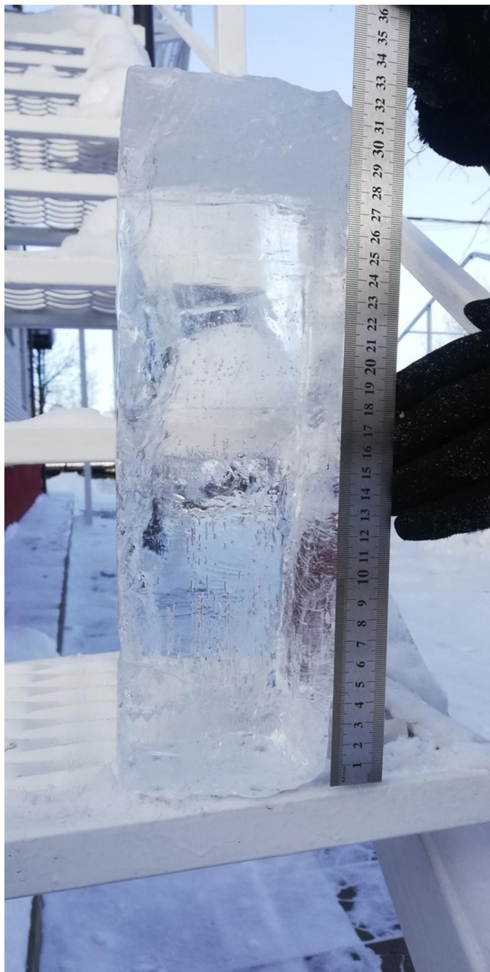
Рис. 1. Исследование толщины образца льда
