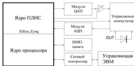
Рис. 1. Рис. 1 Структурная схема комплекса для исследования диодов
