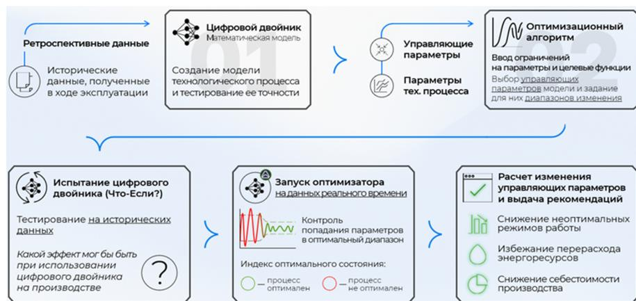
Рис. : Общая схема работы оптимизатора
