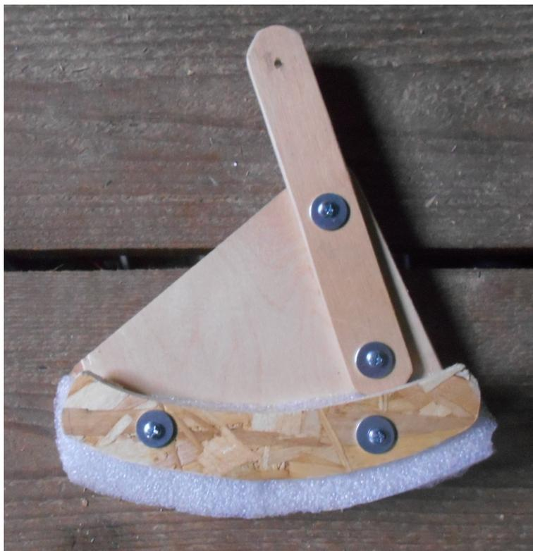
Рис. : 2. Кулачковая шагающая опора (катится и шагает)
