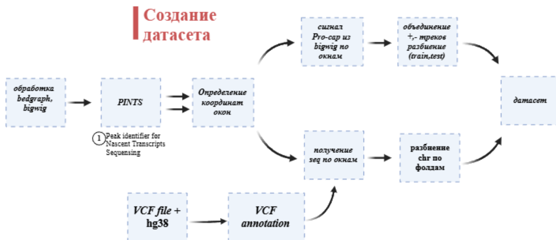
Рис. : Схема обработки данных и получения датасета для дообучения
