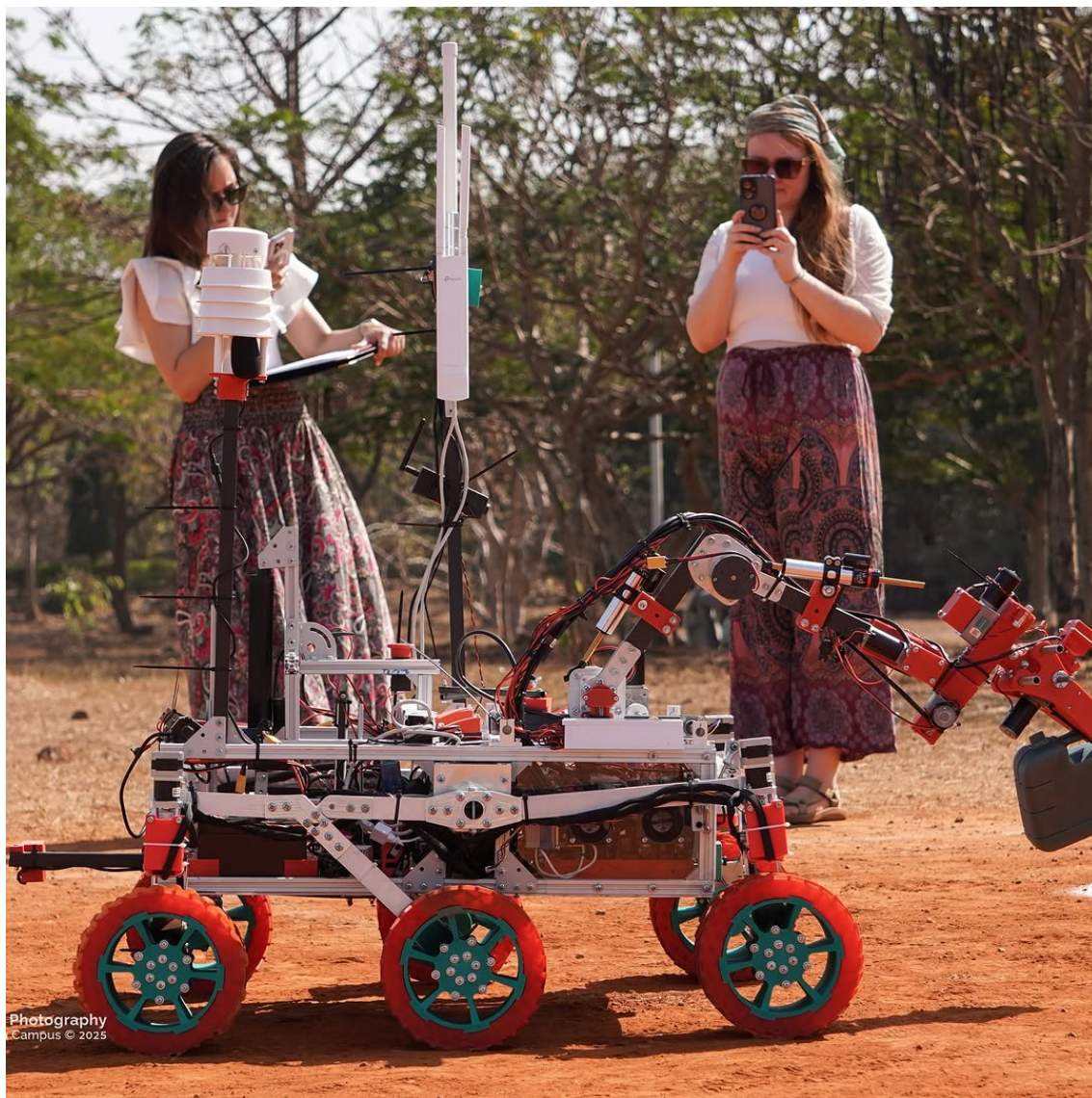
Рис. : EUREKA на соревнованиях IRC2025. Видны гидравлические демпферы на манипуляторе
