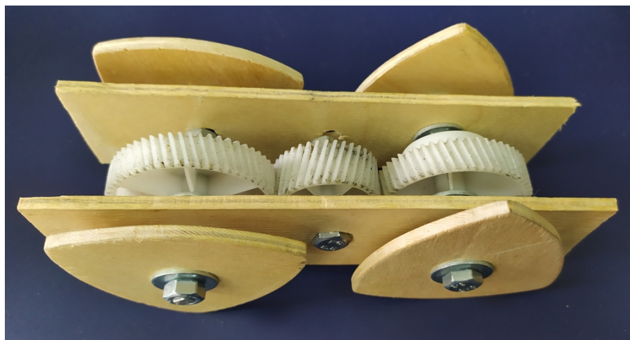
Рис. : 3. Зубчатая синхронизация рёлоколёс в противофазе
