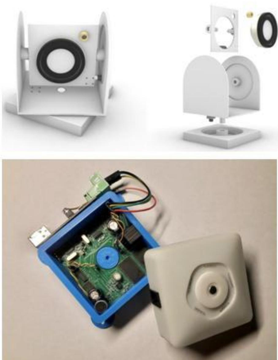
Рис. : 3. Фотографии калибровщика и электронного блока акустической системы
