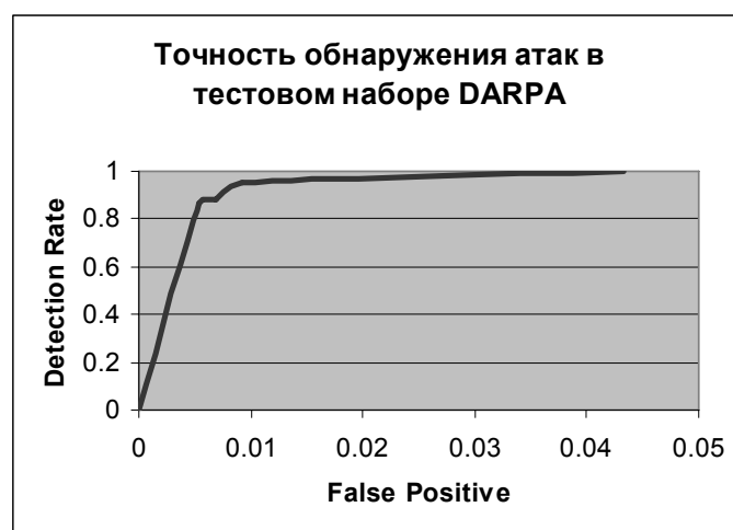
Рис. 4. Точность обнаружения атак методом выявления аномалий в эталонном наборе данных DARPA 1999
